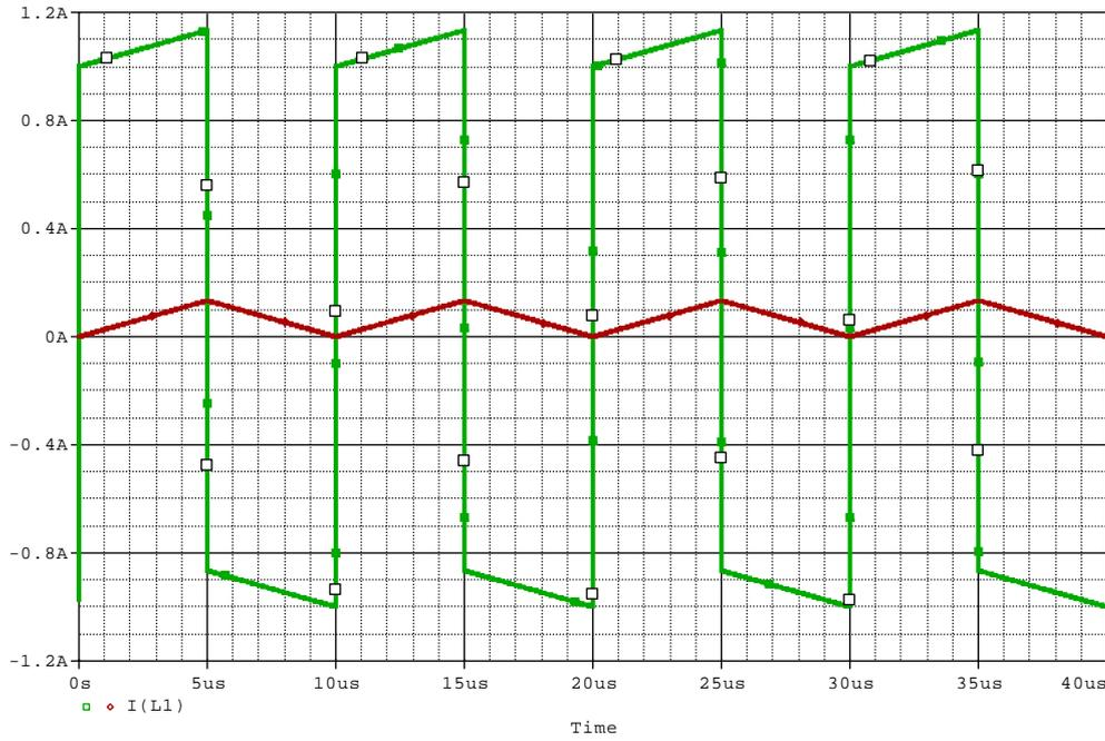
**Fig. Sol7.** Corriente de entrada total al transformador en el problema 7 (verde para  $R_L = 1\text{ k}\Omega$ ; rojo para  $R_L \rightarrow \infty$  (circuito abierto)).
