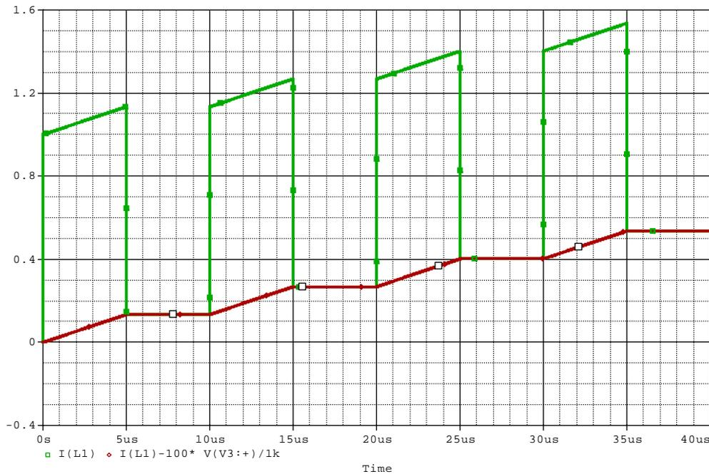
**Fig. Sol8.** Corriente de entrada total al transformador en el problema 8 (verde) y corriente magnetizante (rojo). En los intervalos en que  $v_I = 0$  y la corriente magnetizante es constante, la corriente de entrada coincide con la corriente magnetizante, ya que la corriente de salida es nula al ser  $v_2 = 0$  también.
