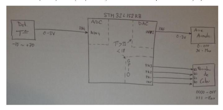
2) Se utilizan 3 periféricos, el GPIOA, el ADC y el DAC. No se utiliza interrupciones en ninguno por indicación del enunciado.
