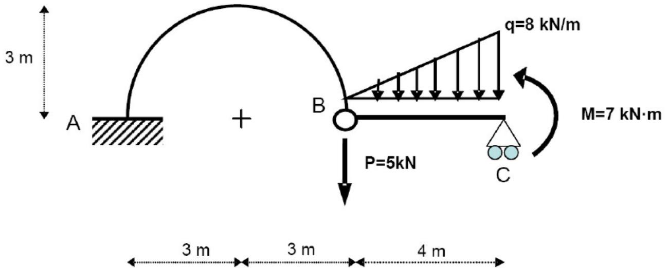
**PROBLEMA 15:** Determine los diagramas de esfuerzo cortante y momento flector de la siguiente estructura. Dibuje dichos diagramas, acotando sus valores característicos.
