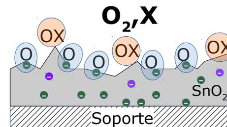
Si hay gases reductores (X), algunos átomos de oxígeno se recuperan y los electrones vuelven al material
