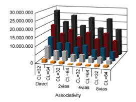
adjunta, puedes comprobar el índice de fallos de caché originado por accesos a la RAM en diferentes configuraciones de INTEL.
