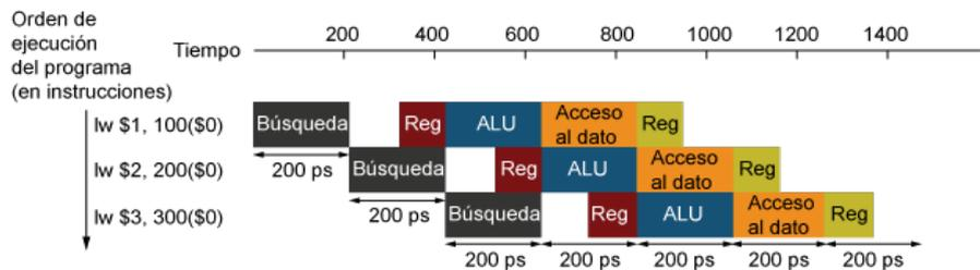
Tal como se aprecia en la imagen, aunque la ejecución de tres instrucciones en una unidad monolítica, consume  $800\text{ps} \times 3 = 2400\text{ps}$ , mientras que nuestra unidad segmentada solo necesita 1400 ciclos, siendo un 71% más rápida.
