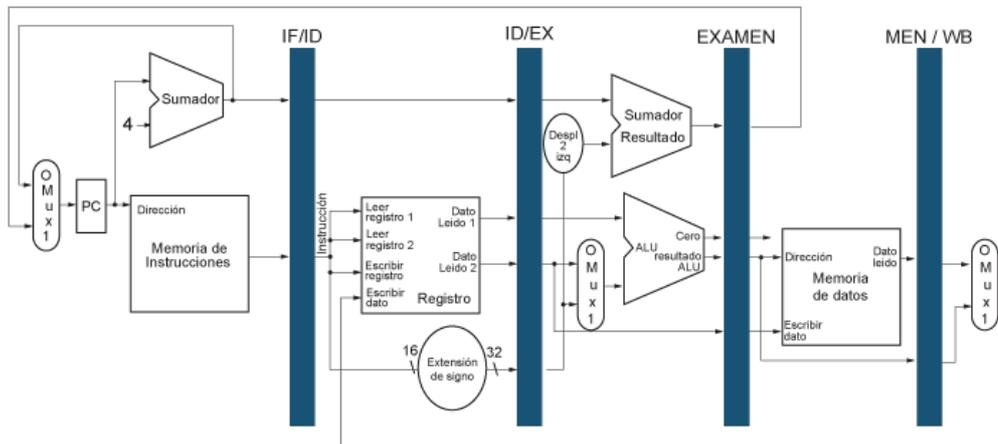
En la imagen anterior vemos cómo la unidad de control se ha dividido en segmentos, cada uno de los cuales puede hacer una fase de la ejecución completa de una instrucción. Esta unidad se ha dividido concretamente en cinco fases y, dado que ahora la instrucción tiene que avanzar a través de las fases, se necesita un lugar de intercambio.
