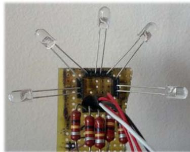
Una pequeña descripción de cómo funciona este juego de fotodiodos es que al incidir la luz más a uno que otro, evaluaremos el máximo y ese estará conectado a una entrada digital del Arduino que dará un nivel alto y se desplazara hacia donde ha captado esa luz.
