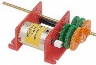
Estos serán los encargados de proporcionar la potencia necesaria a las ruedas para poder realizar el desplazamiento del coche. Estos motores al demandar una potencia que el Arduino es incapaz de dar debemos de conectar entre ambos una etapa de potencia constituida por un Controlador dual de puente completo (L298N) y dos puentes de diodos. La etapa de potencia quedaría como mostramos en la siguiente figura:
