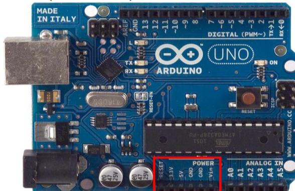
Bien alimentemos al arduino mediante la conexión USB o mediante una fuente externa (recomendada de 7-12V), vamos a tener unas salidas de tensión continua debido a unos reguladores de tensión y condensadores de estabilización. Estos pines son:
