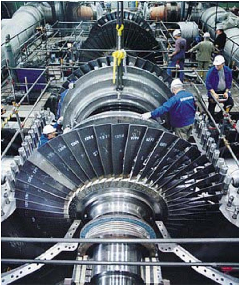
El vapor generado se expande en la turbina, mueve los álabes y el eje, ese eje está unido a un alternador eléctrico y se produce electricidad
