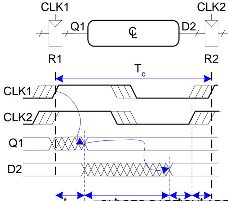
$$T_c \geq t_{pcq} + t_{pd} + t_{setup} + t_{skew}$$
