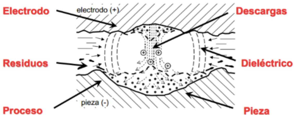
Los procesos anteriores (mecanizado electroquímico, rectificado electroquímico) y este de electroerosión consiguen un buen mecanizado superficial. Las profundidades del mecanizado no son muy elevadas. A pesar de ello, en el proceso electroquímico y en el de electroerosión podemos conseguir mayores profundidades.
