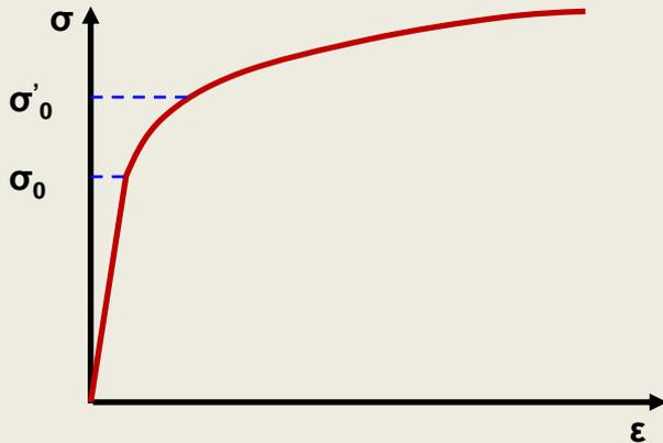
**Hipótesis 2.-** La tensión de fluencia es función de la def. plástica equivalente
