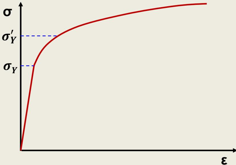
Considérese la gráfica tensión-deformación  $\sigma_1 = f(\epsilon_1)$  obtenida en un ensayo de *tracción uniaxial* a lo largo del *eje 1*.
