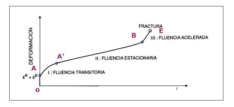
Parte de la deformación lograda en la primera etapa (fluencia primaria o transitoria) puede recuperarse: <u>deformación viscoelástica</u>
