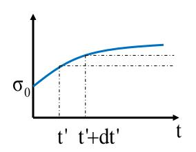
En el límite de incrementos <u>infinitesimales</u> de tensión, lo anterior se transforma en un integral (incremento "suave" de  $\sigma$ ):
