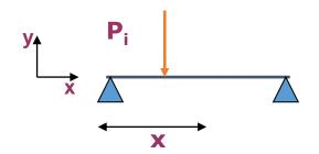
Aparece un campo de tensiones normales en la sección de la barra  $\overline{\sigma}(x,y)$  que verifican las ecuaciones de equilibrio interno.
