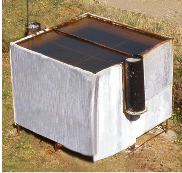
Fig. 10.6. Experimental solar pond (Karakilcik et al., 2006a).
