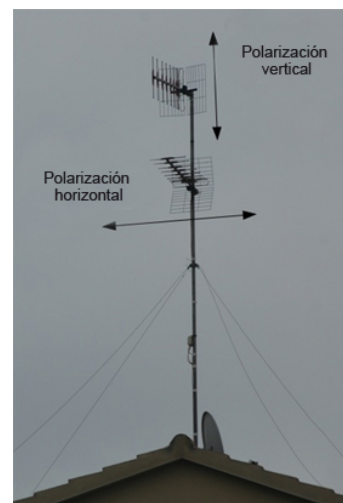
Figura 13. Antenas con polarización horizontal y vertical; ejemplo PDMA lineal
