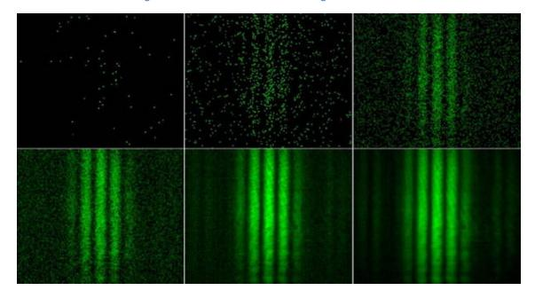
Figura 3 Secuencia de formación de una figura de difracción
