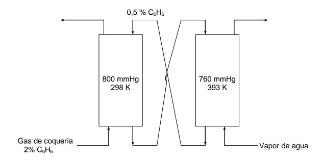
En la columna de absorción de 1 m de diámetro, se han de tratar 1184,4 m3/h de gas de coquería a 800 mmHg y 298 K con un contenido del 2% en volumen de benceno. El aceite mineral contiene un 0.5% en moles de benceno, y ha de utilizarse 1,5 veces el mínimo necesario para conseguir una recuperación del 95% del benceno alimentado. Puede suponerse que la temperatura de la columna de adsorción permanece constante e igual a 298 K.
