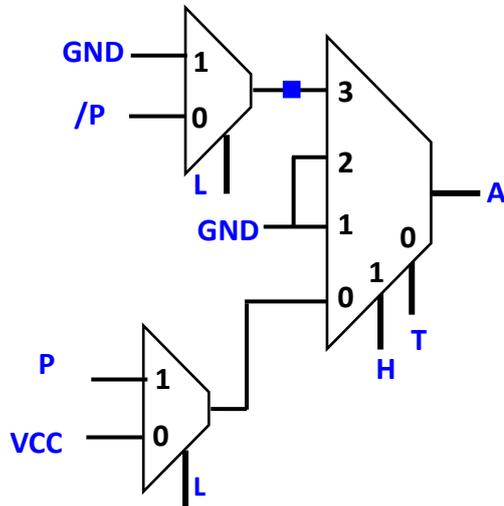
Otra posible solución sería utilizando P como variable de control de la segunda línea de multiplexores.
