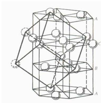
2.- En la figura aparece representado un empaquetamiento hexagonal compacto de esferas de radio  $r$ . Como en el caso anterior, calcule el porcentaje de ocupación del empaquetado.
