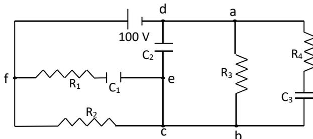
28. Examen (Sep. 1996-97): Dado el circuito de la figura, tanto las baterías como el amperímetro tienen resistencias internas despreciables.
