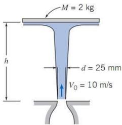
7.- Un disco de 2 kg de masa recibe el golpe de un chorro vertical de agua (densidad  $1000 \text{ kg/m}^3$ ) en su cara inferior. Con los datos de la ilustración, determine la altura  $h$  a la que el disco se encuentra en equilibrio. Asuma que el chorro fluye en régimen de Bernouilli y que la presión en él es la atmosférica.
