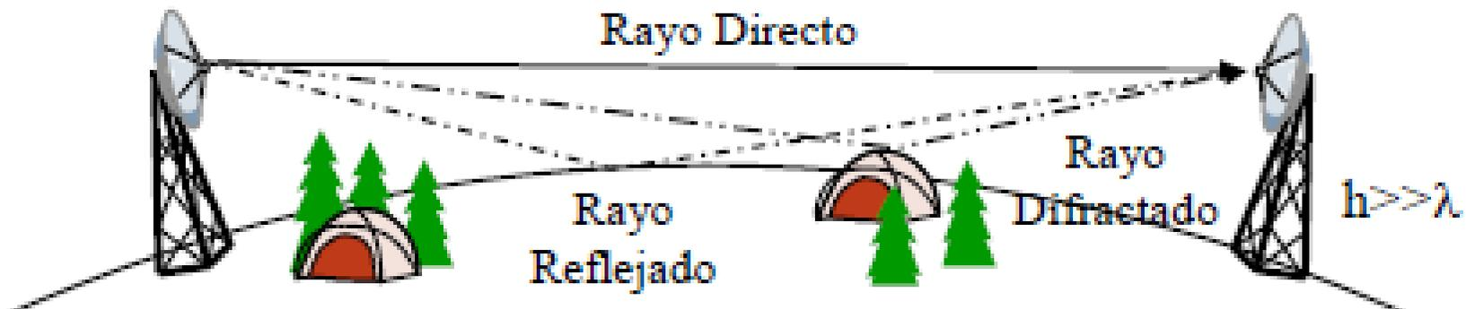
En la mayoría de los casos, sobre todo en las bandas de microondas, se requiere enlace visual entre antenas con lo que se limita el alcance a la línea del horizonte.
