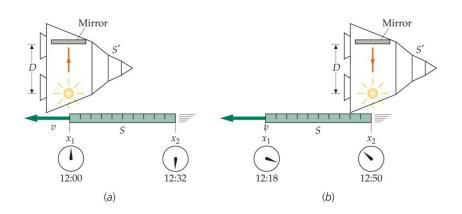
Ejemplo 39.6: se observa que el reloj de la derecha (el rezagado) adelanta en 32 minutos respecto al de la izquierda (el adelantado).
