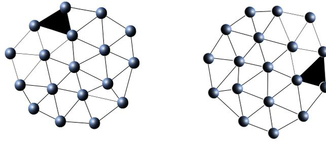
**Figura 5.** Un sólido rígido entendido como un sistema de partículas unidas por barras rígidas. El movimiento entre dos instantes puede descomponerse como la suma de una translación del centro de masas y una rotación respecto del mismo.
