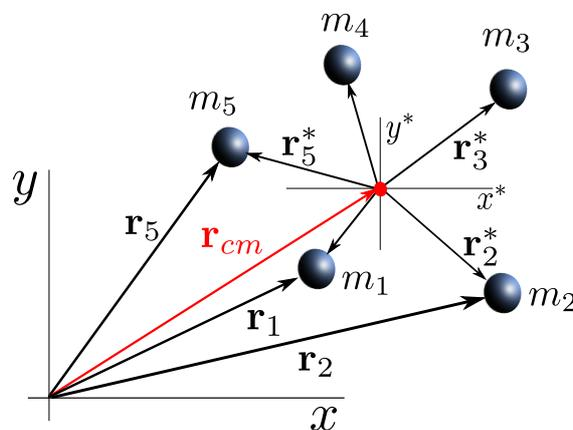
**Figura 4.** Sistema de referencia del centro de masas  $O^*$  junto con un sistema de referencia inercial  $O$  fijado en el espacio absoluto newtoniano.
