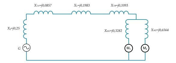
h) Si el motor M1 mueve una carga de 120MW y el M2 otra de 60MW, ambas con factor de potencia unidad y con una tensión de 12,5kV. ¿Cuál es la potencia consumida total por la carga en valores p.u.? (0,5 puntos)
