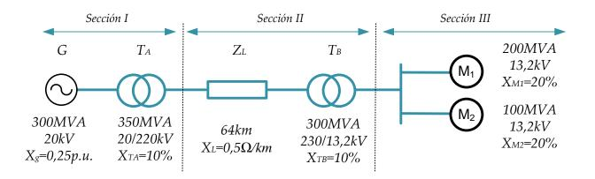
*b) Obtener las tensiones base en cada sección del sistema eléctrico.* **(0,25 puntos)** Como valores base se toman los del generador.
