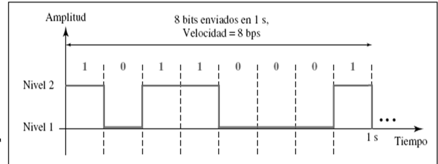
a. Una señal digital con dos niveles
