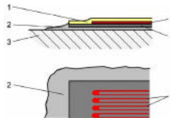
1: lámina de cubierta, 2: pegamento,
