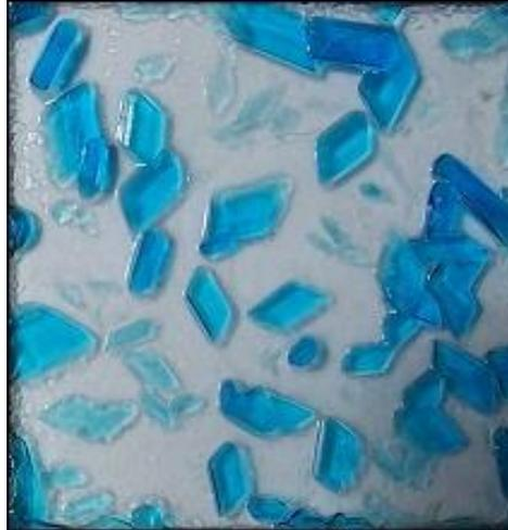
Ejemplo: Nucleación de Sulfato de cobre a partir de una solución acuosa sobresaturada
