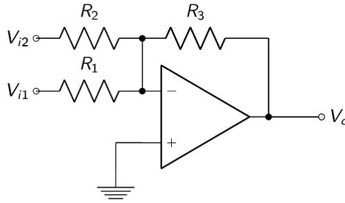
Calcular los valores necesarios de  $R_1$  y  $R_2$  si se desea que  $V_o$  se corresponda con la siguiente función:
