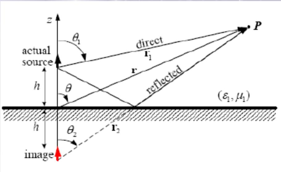
El campo en el punto de observación P es una superposición de los campos de la fuente real y la fuente imagen, ambos radiando en un medio homogéneo. La fuente real es un elemento de corriente (dipolo)
