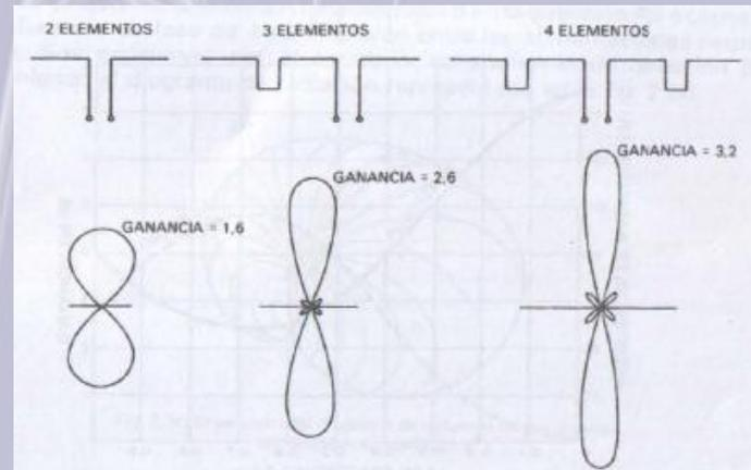
Entre los dipolos de media onda se encuentran una líneas de longitud  $\lambda/4$  que no afectan a la radiación de la antena
