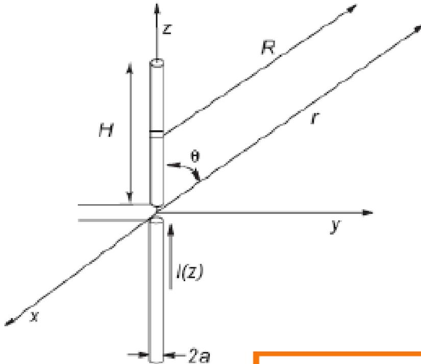
Antena cilíndrica: Hilo fino conductor de longitud  $2H$  ( $a \ll \lambda$ ). Las dimensiones de la antena no son pequeñas en términos de  $\lambda$ , la aproximación de corriente uniforme no es cierta.
