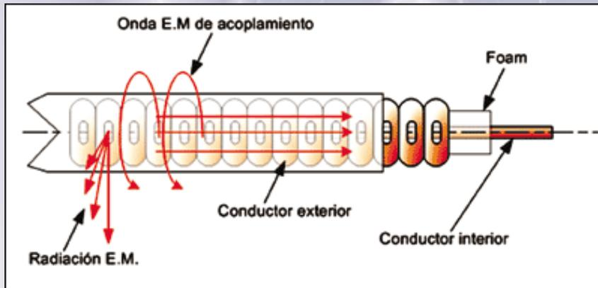
Como se muestra en la Figura, a través de las ranuras practicadas en la cubierta conductora exterior, parte de la energía E.M transmitida por el conductor interior puede ser irradiada hacia el exterior del cable. Al mismo tiempo, las emisiones E.M del exterior pueden ser transferidas hacia el interior del cable, de manera que las funciones de transmisión y recepción puedan ser realizadas en forma simultánea en toda la longitud de éste.
