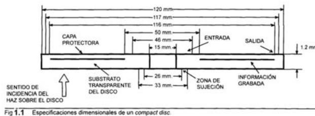
Fig.1.1 Especificaciones dimensionales de un compact disc.
