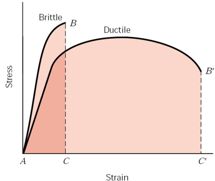
Representación esquemática de los ensayos de tracción de
