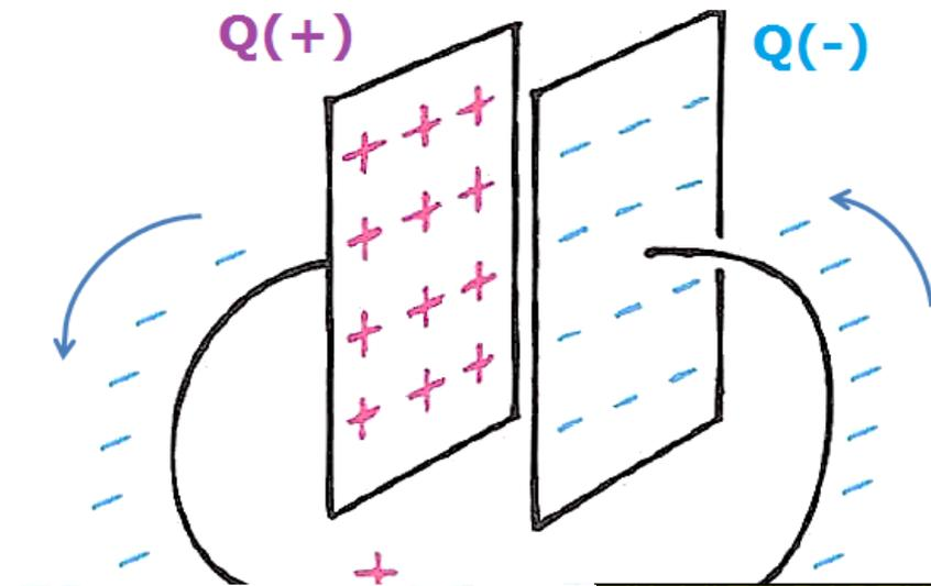
Los condensadores son dispositivos formados por dos placas conductoras, muy cercas entre sí, ambas placas poseen
