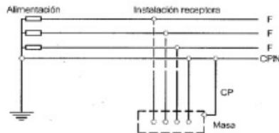
Esquema TN-C-S: En el que las funciones de neutro y protección están combinadas en un solo conductor en una parte del esquema (figura 3).
