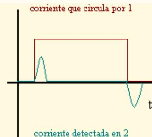
Faraday: "La variación del flujo magnético que enlaza a un circuito produce una f.e.m. que se opone a la variación del flujo magnético"
