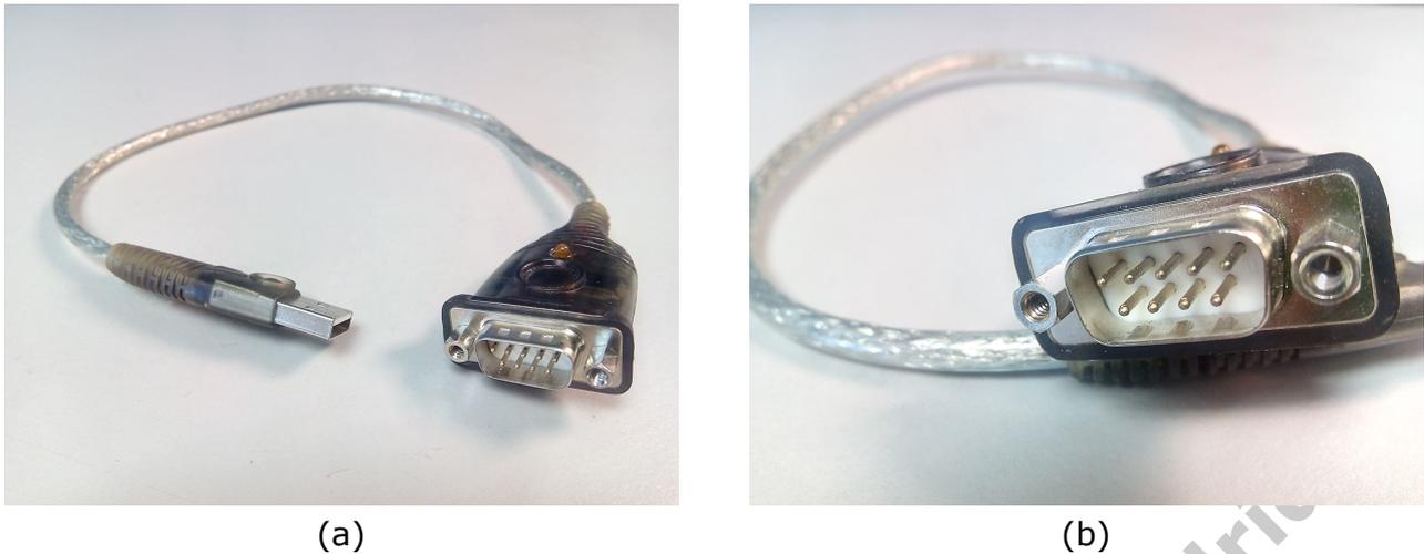
Figura 3: Adaptador de puerto USB a RS232 (a). Detalle del conector macho DB9 para RS232 (b). Los pines están numerados aunque, en la práctica, basta con usar los pines 2 y 3 (TX y RX).
