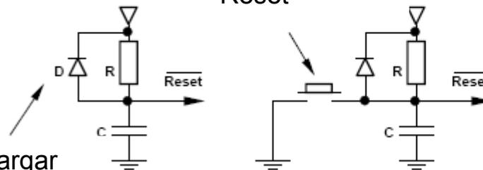
Diodo para descargar rápidamente C en caso de fallo de alimentación para producir un reset
