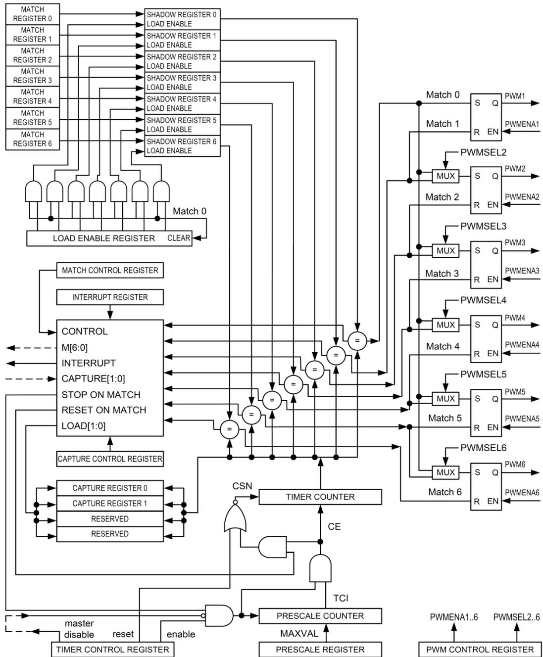
Fig. 22 Arquitectura interna del bloque PWM
