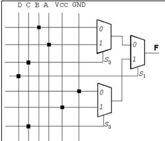
**U2\_20.** Se pide implementar la función  $F(A,B,C,D) = \Sigma m(2,6,9,11,13)$ , utilizando exclusivamente, todos los multiplexores de cada uno de los dos esquemas mostrados.
