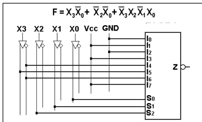
**U2\_16.** Dado el circuito de la figura se pide, resolver la misma función utilizando un multiplexor 4-1. Utilizar las variables A y B como señales de control S<sub>1</sub> y S<sub>0</sub> respectivamente.
