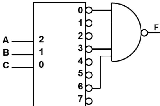
**U2\_28.** Dado el circuito de la figura adjunta, donde se representa la función  $Z(A,B,C)$ , se quiere implementar dicha función Z utilizando un multiplexor 4-1 y el menor de número de puertas lógicas posible. Se pide realizar el diseño del circuito, justificando brevemente el diseño, dibujando el multiplexor y las puertas utilizadas, señalando en cada caso las entradas y salidas que se utilicen en el mismo. Utilizar A y B como variables de control, tomando A como la variable de mayor peso.
