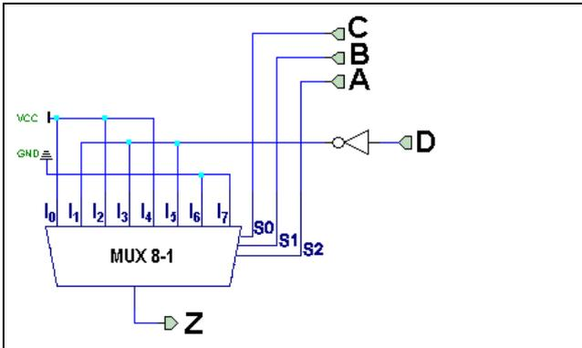
**U2\_11.** Un cierto circuito lógico con 4 variables de entrada A, B, C, y D sirve para resolver las funciones lógicas F y G. La función F vale '1' siempre que valgan '1' dos o más señales de la entrada, en otro caso F vale '0'. La función G vale '1' siempre que valga '1' un número par de señales de la entrada, en otro caso G es el complemento de F. Se pide:
