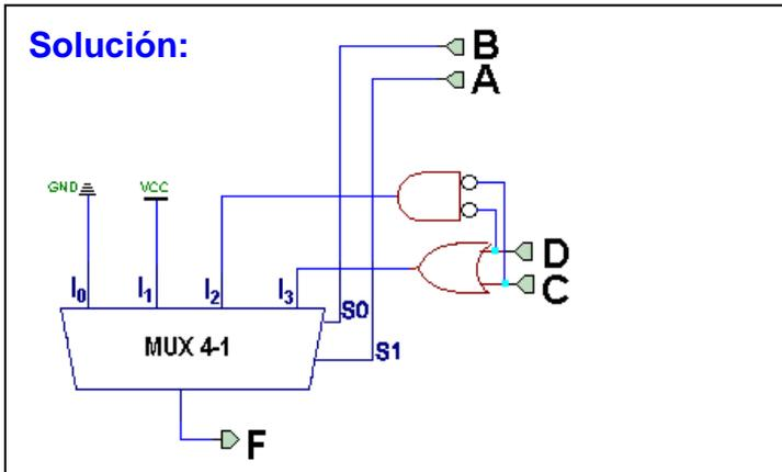
**U2\_13.** Se desea realizar la misma función lógica de 5 variables que realiza el circuito de la figura, pero utilizando un multiplexor 8-1. Utilizad las variables C, D y E como líneas de control de mayor a menor peso respectivamente.
