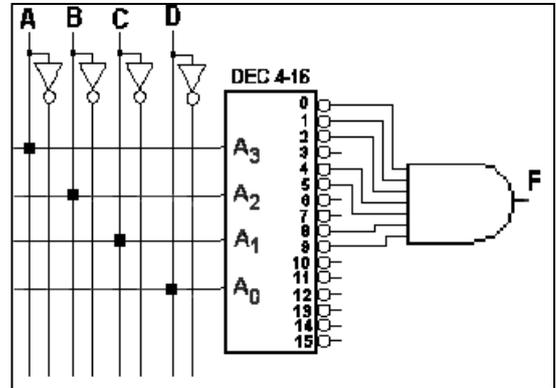
**U2\_18.** Dada la función lógica  $F(A,B,C,D) = \sum m(1,2,3,6,9,15)$ , impleméntela utilizando EXCLUSIVAMENTE los dispositivos de la figura adjunta, marcando con un punto o una cruz los cables que están conectados.
