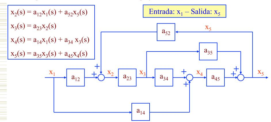
Diagrama de bloques de un motor controlado por inducido
