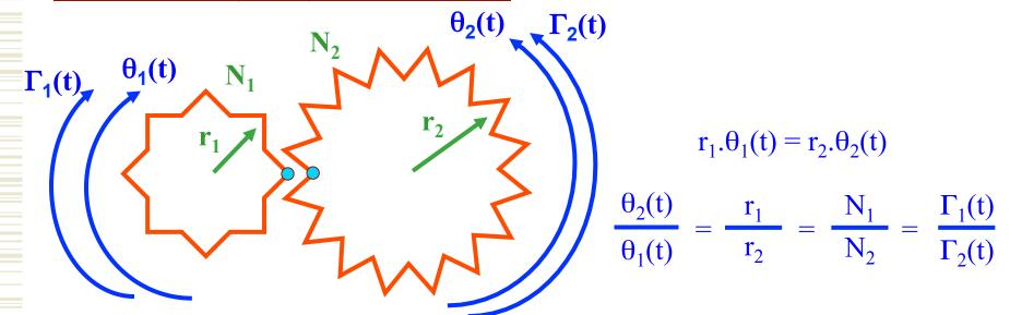
Propiedad: la impedancia de sistemas rotacionales se trasmite a través de trenes de engranajes multiplicándola por:
