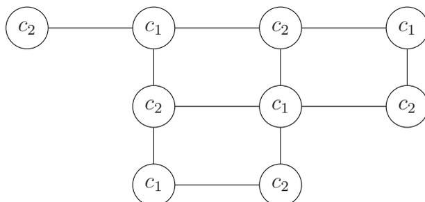
Puesto que el grafo puede colorearse con dos colores es bipartido. Los conjuntos de vértices que tienen asignados el color  $c_1$ ,  $V_1$ , y los que tienen como color  $c_2$ ,  $V_2$ , forman una partición del conjunto de vértices inicial y, además, sólo hay aristas que van de  $V_1$  a  $V_2$ . Por otro lado, es obvio que el grado cromático de un grafo bipartido con aristas es 2.
