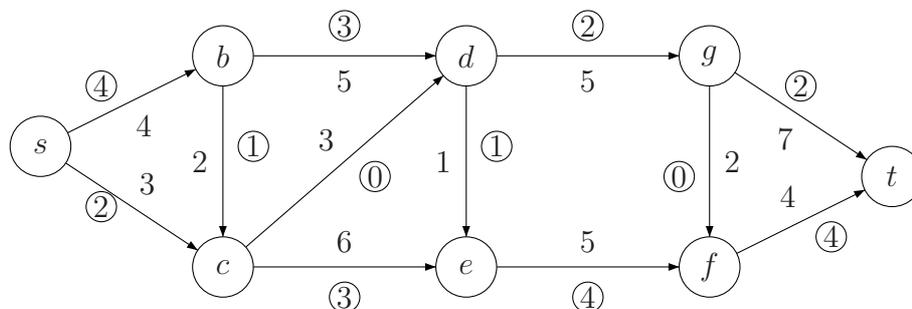
**Teorema 6.31** El valor máximo de un flujo de  $s$  a  $t$  en una red es igual a la capacidad mínima de un corte que separe a  $s$  de  $t$ .
