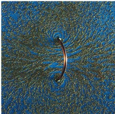
Líneas campo magnético de una espira de corriente circular visualizadas mediante limaduras de hierro.
