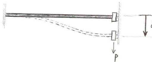
Figura 4.8 Viga bi-empotrada con un extremo móvil.
