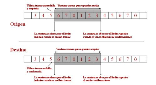
El siguiente gráfico ilustra un ejemplo en el que se utiliza una ventana W = 3. La notación que se utiliza en el ejemplo es la siguiente:
