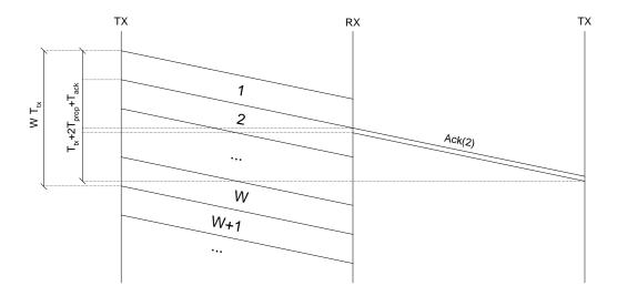
El caso en el que la anterior condición no se cumpla (W < 1 + 2a), procedemos de la siguiente forma para calcular la eficiencia. Puede verse que el intervalo indicado en el gráfico adjunto va a repetirse periódicamente, puesto que vamos a tener una ráfaga de W transmisiones, que provoca la recepción de una ráfaga de W confirmaciones, con un tiempo de transmisión entre dos confirmaciones consecutivas, lo que nos lleva de nuevo a mandar una nueva ráfaga de W tramas.
