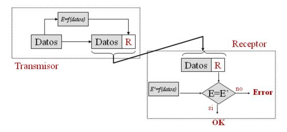
La clave del método anterior reside en cómo calcular la redundancia (R). Un posible mecanismo es el denominado **paridad**, que añade un bit a la secuencia de datos indicando si el número de 0's es par o no:
