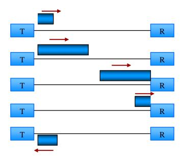
A continuación se analizan las prestaciones del protocolo parada y espera. El parámetro en el que se basa la evaluación es la eficiencia U, que es el porcentaje máximo de tiempo en el que el enlace puede ocuparse para transmisiones de datos (tiempo empleado para transmisiones utiles). En un canal ideal la eficiencia es del 100%.
