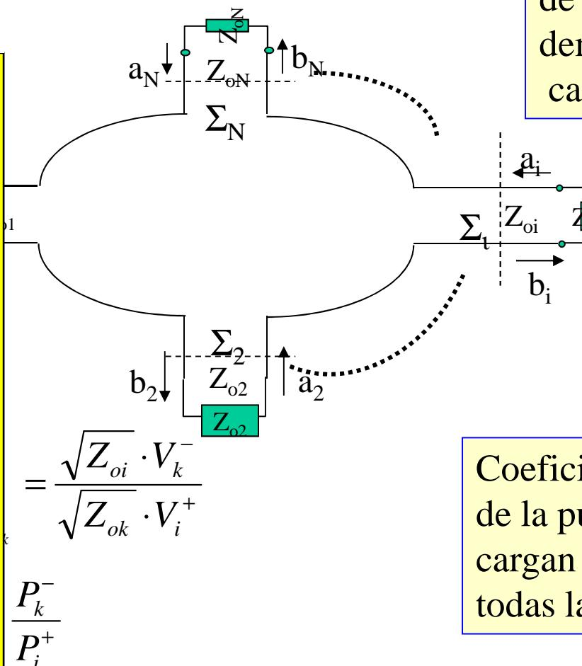
Coeficiente de reflexión de potencia de la puerta  $i$  cuando se cargan las demás puertas con la impedancia característica
