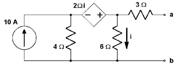
11.- En el circuito de la figura, calcular  $V_{Th}$ ,  $I_N$  y  $R_{eq}$  entre los terminales A y B.
