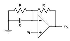
9.- (a) Obtener la expresión de la ganancia de tensión v<sub>o</sub>/v<sub>in</sub> del circuito que se muestra en la figura.
