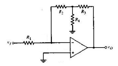
**16.-** Demostrar que el circuito de la figura se com porta, respecto a la carga R, com o una fuente de corriente, gobernada por la tensión  $V_i$
