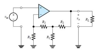
**10.-** Suponiendo los amplificadores operacionales ideales, y  $R_1 = 2x10^4 \Omega$ ,  $R_2 = 2x10^5 \Omega$  y  $R_3 = 10^4 \Omega$ .
