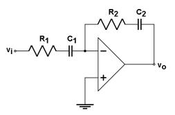
**15.-** Calcular la ganancia de tensión  $v_0/v_i$  del siguiente circuito.
