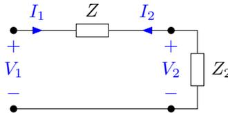
La red es recíproca pero no simétrica, pero intercambiar los puertos 1 y 2 es equivalente a intercambiar las impedancias  $Z_1$  y  $Z_2$ . Por tanto
