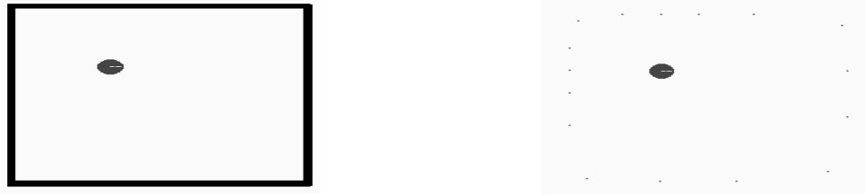
Figura 20: Ejemplo de un robot en un entorno simple (izda) y datos muestreados por sonar (dcha).
