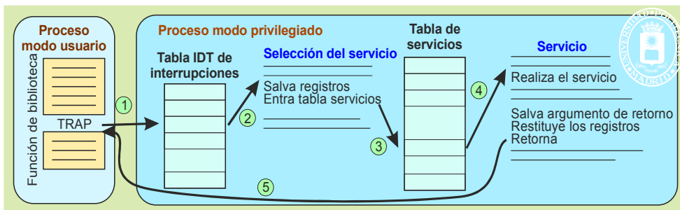
Figura 3.36 Ejecución de un servicio que no presenta espera en un sistema operativo con ejecución dentro de los procesos de usuario.
