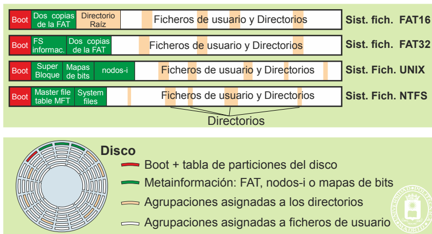
Figura 5.19 Formato básicos de varios sistemas de ficheros.
