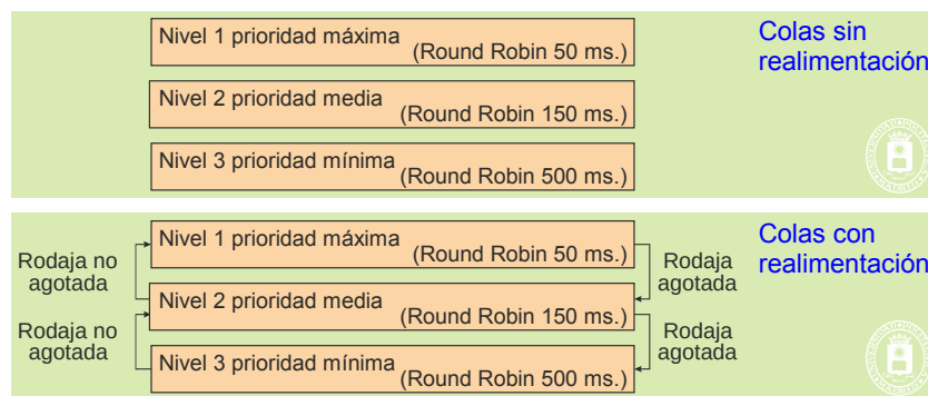
Figura 3.42 Colas multinivel con y sin realimentación
